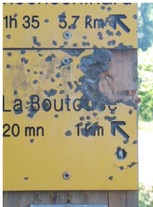
Poteau dégradé par des tirs (plombs)
